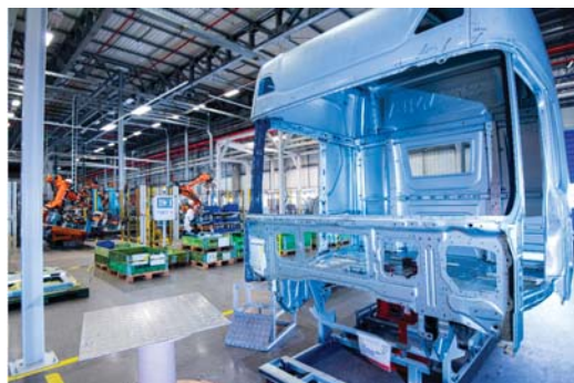
Figura 11: Fábrica de Solda – Cabina Soldada Fonte: Arquivo da Empresa.
